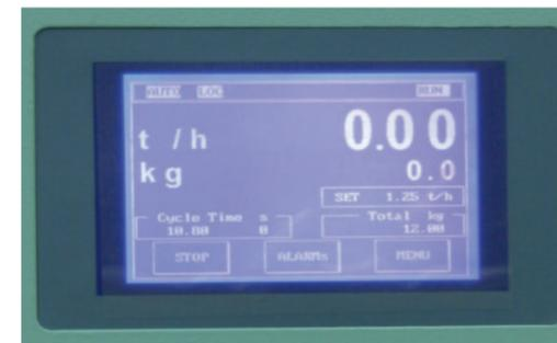
La manipulation du tableau de commande tactile est simple d'utilisation et facilite la mise en œuvre. A l'aide de quelques touches uniquement, les dates nécessaires pour le fonctionnement de la machine peuvent être introduites, et des éventuelles irrégularités sont rapidement signalées. La page principale du menu indique le débit de passage, le poids et les paramètres fondamentaux d'utilisation.
