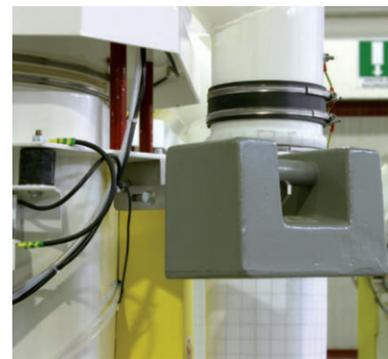
Le calibrage et le contrôle périodique peuvent être effectués facilement et rapidement par le placement de poids standards sur deux bras fixés sur l'entonnoirs. La commande donne des impulsions pour le suivi de la valeur de calibrage. A chaque divergence de calibrage, la valeur sera automatiquement remise à la valeur initiale. Le rendement optimale de l'installation est ainsi atteint.
