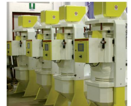
De nos jours, il ne faut pas négliger les systèmes de communication. Trois systèmes sont disponibles: Profibus DP / Modbus / TTY (current loop). Le système de balance automatique à un entonnoir type PES peut parfaitement être intégré dans de nouveaux systèmes d'automatisation, et d'autres systèmes déjà existants peuvent être remplacés sans autres.
